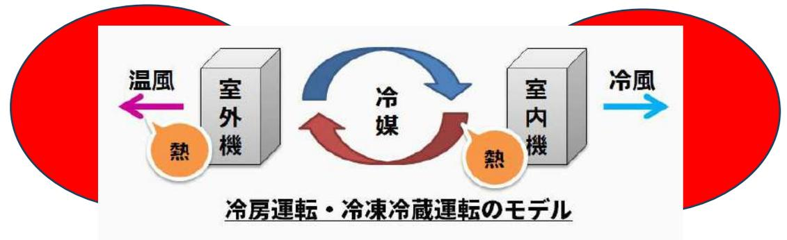
1, 2、夏期、吸入口から熱交換機のフィンの隙間を通るため、取り込まれる空気が高温となり、高圧カットの原因になります。室外機周辺のスペースが狭い場合や、周りに壁やモノがあり風通しが悪いと排熱した高温の空気を再度吸い込むショートサーキットと呼ばれる状態になり、重度の高圧カットになりやすいため要注意です。
