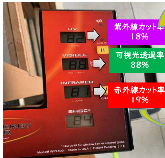
施工前の窓ガラス面
