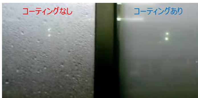
スケッチ断熱ガラスコート塗布・未塗布の結露状態の違い
