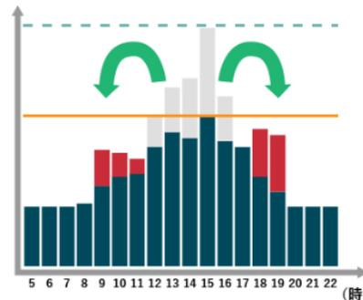
ピーク時間の電力を他の時間に移動させる
